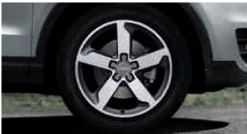
Llantas de aleación con diseño de 5 brazos pulidas parcialmente , tamaño 7 J x 18 con neumáticos 235/50 R 18
