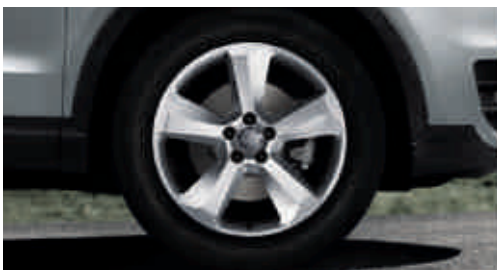
Llantas de aleación Audi exclusive con diseño "Offroad" de 5 brazos tamaño 7 J x 18 con neumáticos 235/50 R 18. Una oferta de quattro GmbH
