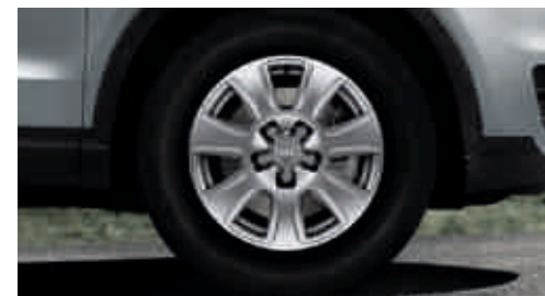
Llantas forjadas con diseño de 7 brazos tamaño 6,5 J x 16 con neumáticos 215/65 R 16
