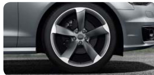
Llantas de aleación Audi Sport con diseño rotor de 5 brazos en estética de titanio mate tamaño 8,5 J x 20 con neumáticos 255/35 R 20 1
