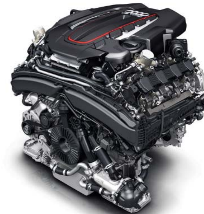
4.0 TFSI con tecnología Audi cylinder on demand
