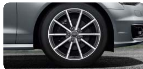
Llantas de aleación Audi Sport con diseño de 10 radios en estética de titanio mate tamaño 8,5 J x 19 con neumáticos 255/40 R 19 1 . (en A6 allroad quattro con neumáticos 255/45 R 19 1 )
