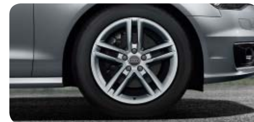
Llantas de aleación Audi Sport con diseño de 5 radios dobles 2 tamaño 8 J x 18 con neumáticos 245/45 R 18 1
