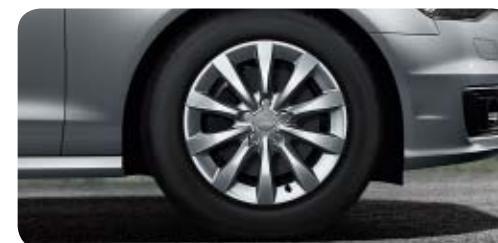
Llantas de aleación con diseño de 10 radios tamaño 8 J x 17 con neumáticos 225/55 R 17 1 , a elección con neumáticos para todas las temporadas
