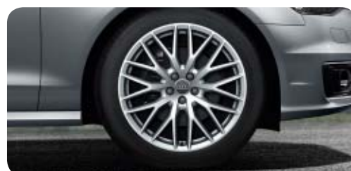
Llantas de aleación Audi Sport con diseño de 10 radios en Y 2 tamaño 8,5 J x 19 con neumáticos 255/40 R 19 1 . (en A6 allroad quattro con neumáticos 255/45 R 19 1 )
