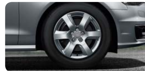
Llantas de aleación con diseño de 6 brazos tamaño 8 J x 17 con neumáticos 225/55 R 17 1
